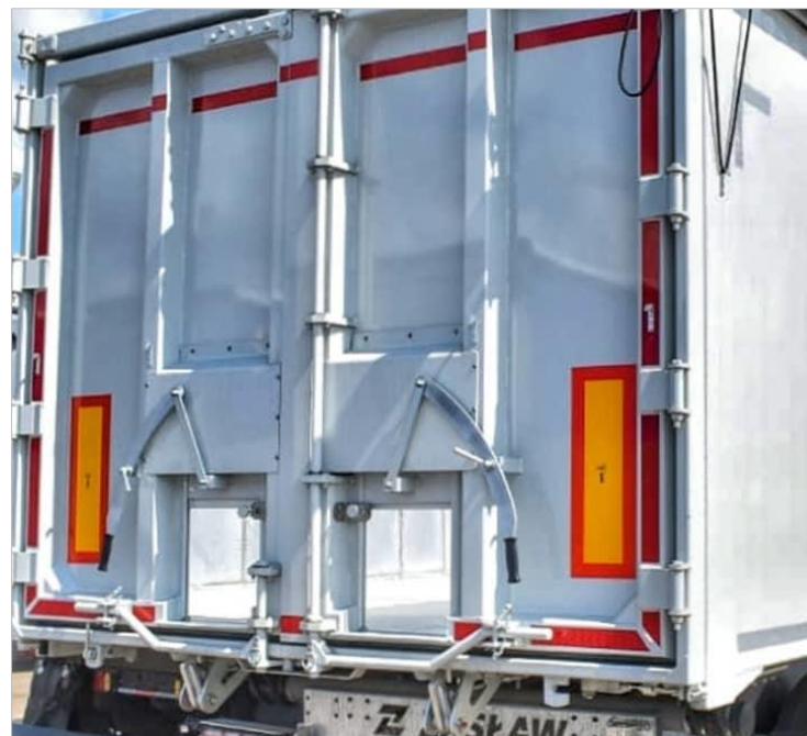
КЛАПАН-ДВЕРИ соотношение 50:50 устанавливается в комплектациях для Украины
