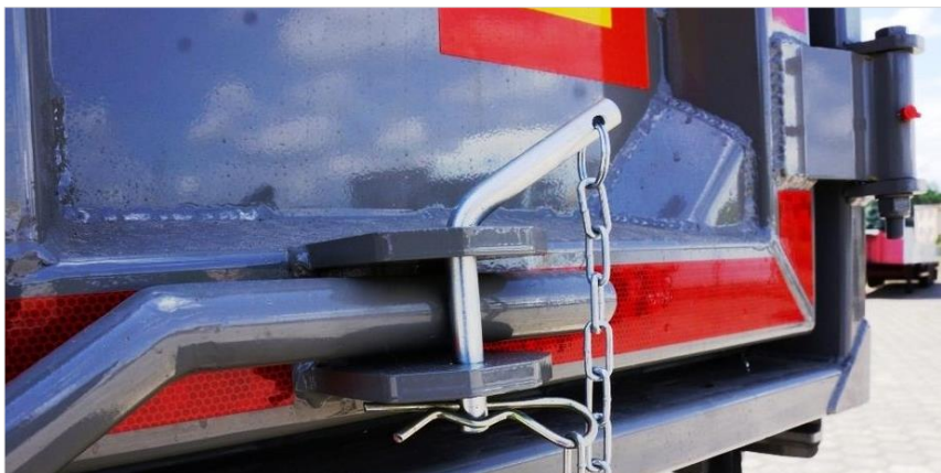
Замок запираания створок в клапан-дверях с фиксатором
